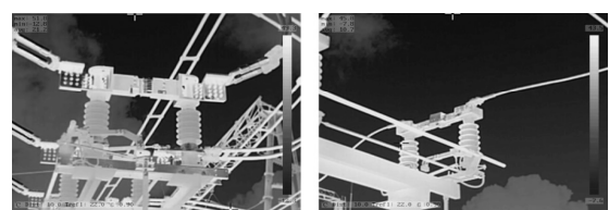
(d) 隔离开关红外图像
