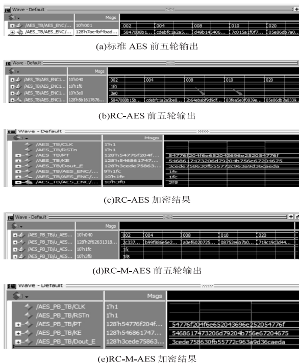
图 6 提出的两种 AES 安全结构的功能仿真结果
