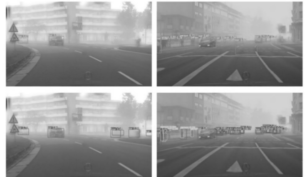
图5 雾天与基础 YOLO 模型的检测效果对比
