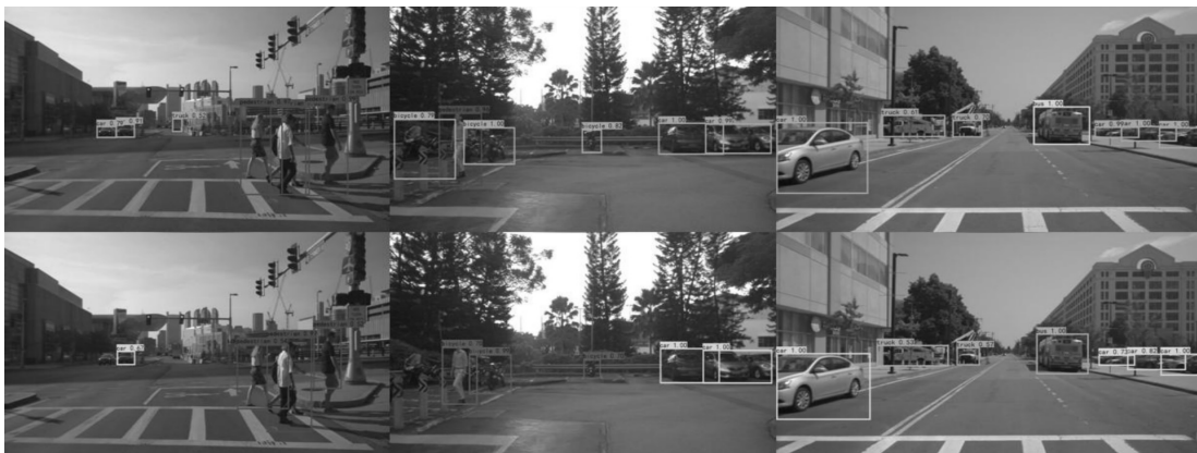
图9 检测效果(上:基于点云和图像的 YOLOv4,下:YOLOv4)
