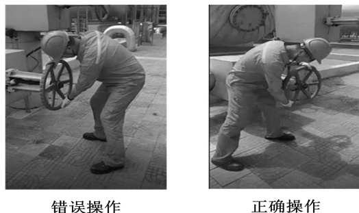
图1 阀门操作示意图
