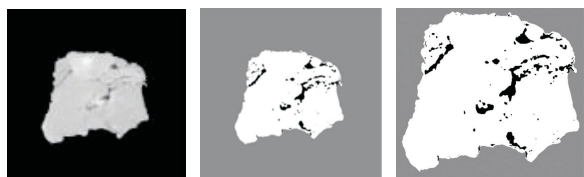
图 4 切片 240.tif 去虚边、分层灰度化与裁剪结果
