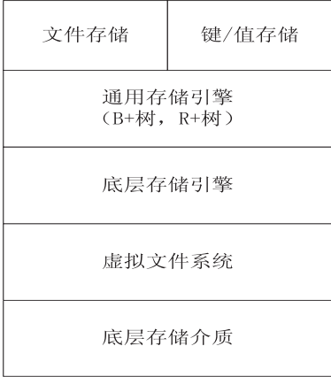
图 2 UnQLite 数据库体系结构
