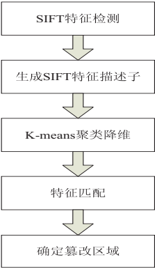
图 2 基于 K-means 的改进 SIFT 算法流程
