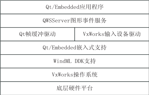
图5 VxWorks 下的 Qt/Embedded 架构
