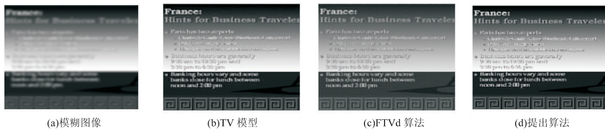
图3 高斯模糊核为 21 \times 21 的各方法复原结果
