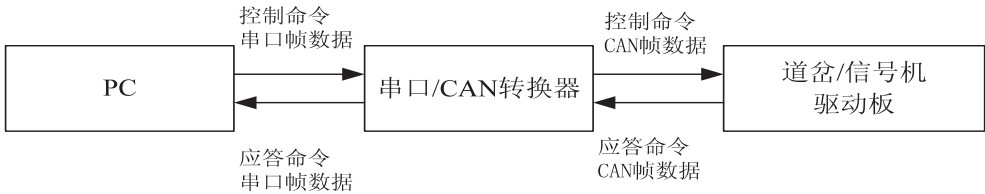
图 1 系统与道岔/信号机驱动板硬件连接图
