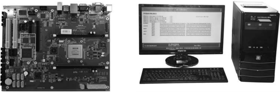
图 5 自主可信主板和基于龙芯处理器的安全可信计算机原理样机
