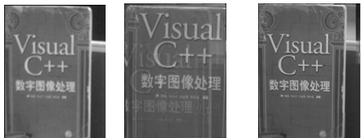
(a)双三次插值放大图 (b)传统 POCS 重建图 (c)文中算法重建图
