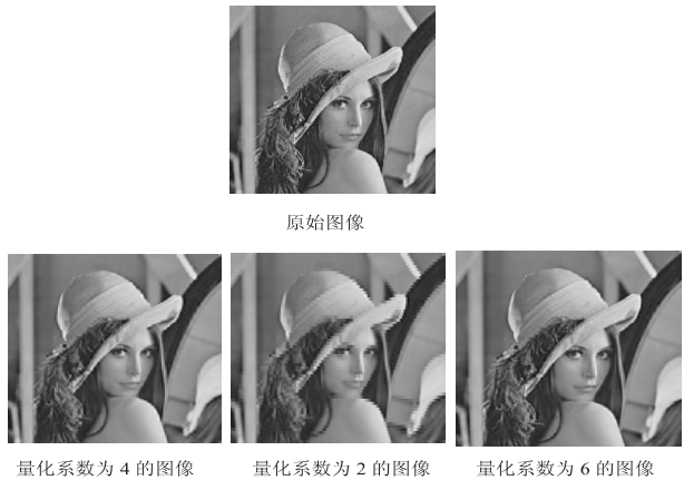
图 2 不同量化系数对应的解码图像
