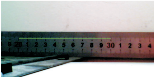
图 3 摄像头中直尺距离所占像素个数
