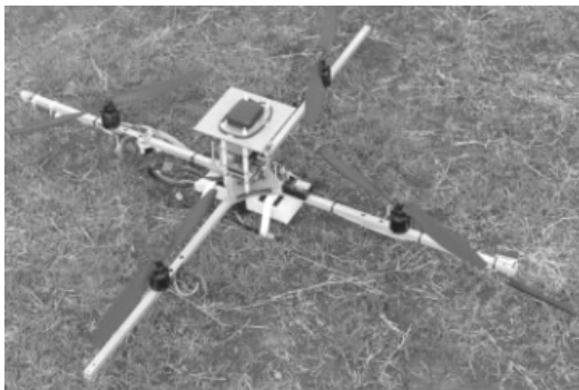
图 1 四旋翼式飞行信标节点
