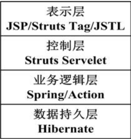
图 2 SSH 架构示意图
