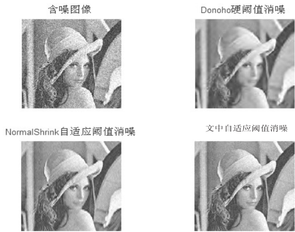
图 3 结合文献[9]改进的阈值函数 去噪效果图( \sigma = 20 )
