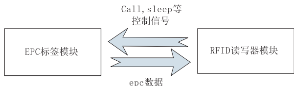
图 1 标签与读写器相互通信示意图
