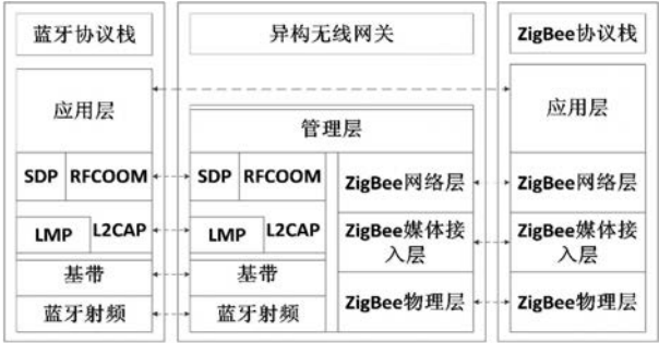
图2 蓝牙/ZigBee 异构无线网络传输系统的协议结构图
