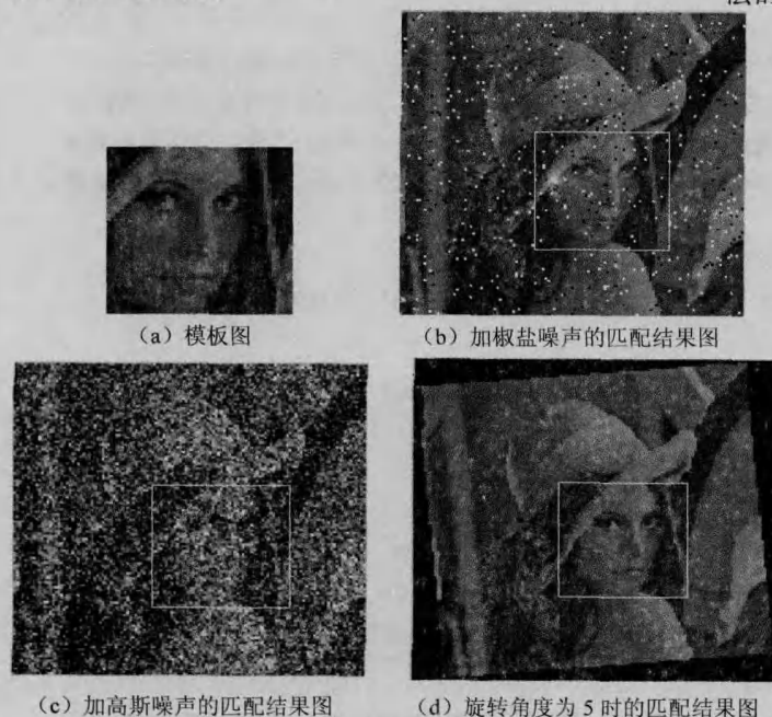
图3 lena.bmp 图像在有噪声和旋转情况时的匹配图
