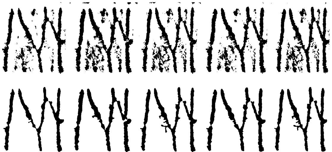
图6 a=1, b=0.8 时的分割效果图以及分割后的去噪结果
