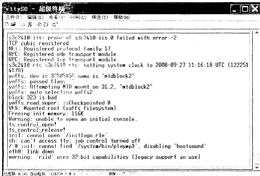
图 3 串口中 Android OS 启动信息
