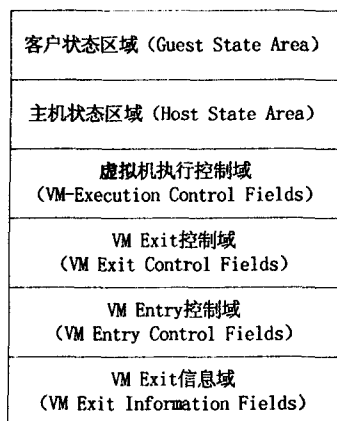
图 3 虚拟机控制结构
