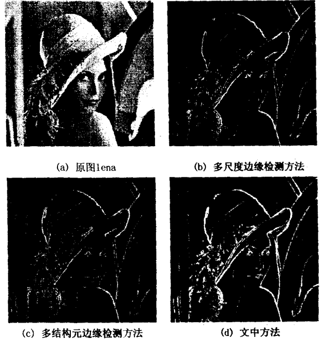
图1 无噪声lena图像的边缘检测结果
