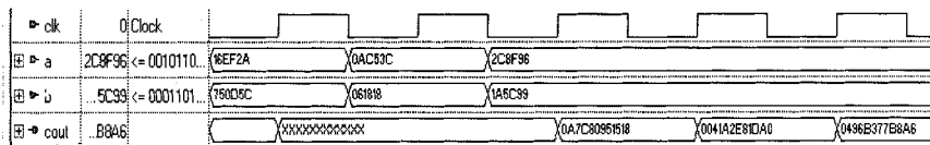
图2 18x18结构乘法器仿真波形
