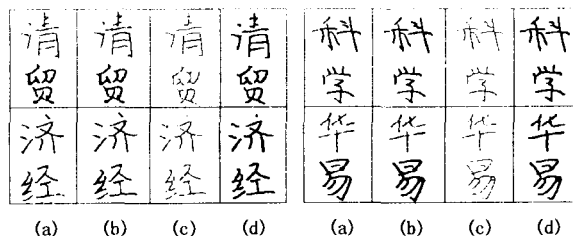
(a) 汉字原图像; (b) 闭运算后的汉字图像; (c) 细化后的汉字图像; (d) 膨胀后的汉字图像(即笔划宽度归一化后的结果)
