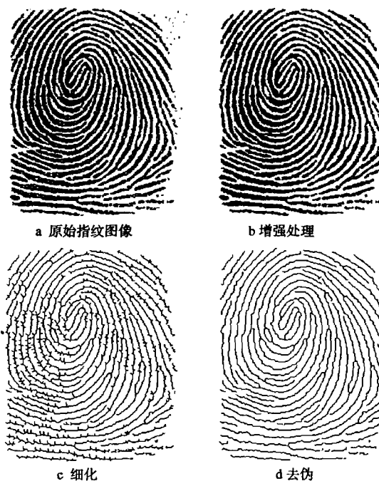
图 6 指纹图像预处理的不同阶段比较
